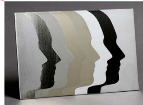
Diese „Köpfe mit Charakter“ wurden am IFAM mittels Laser so bearbeitet, dass sie unterschiedlich auf Wasserbenetzung reagieren und das Licht verschieden reflektieren – sie sind nicht lackiert.
