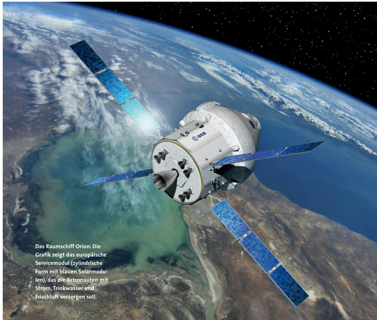
Das Raumschiff Orion: Die Grafik zeigt das europäische Servicemodul (zylindrische Form mit blauen Solarmodulen), das die Astronauten mit Strom, Trinkwasser und Frischluft versorgen soll.
