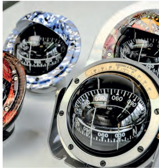
Im Zeitalter der Satelliten-Navigation wirken klassische Instrumente anachronistisch. Doch aus Sicherheitsgründen muss jedes kommerziell betriebene Schiff einen Magnetkompass an Bord haben, der von jeglicher Elektronik unabhängig ist.
