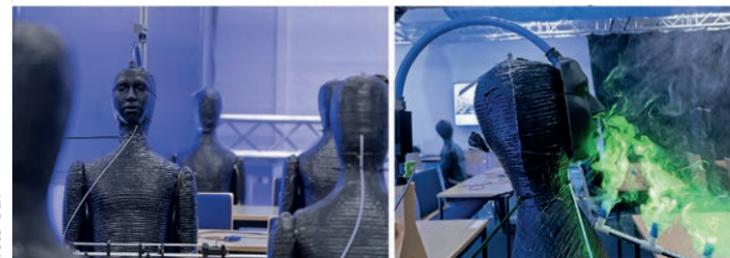
Belastung der Raumluft durch Corona- und Grippeviren reduzieren und damit das Übertragungsrisiko minimieren. Erreicht wird dies durch ein vertikales Lüftungskonzept mit einer Niedrigimpuls-Absaugung an der Decke.
