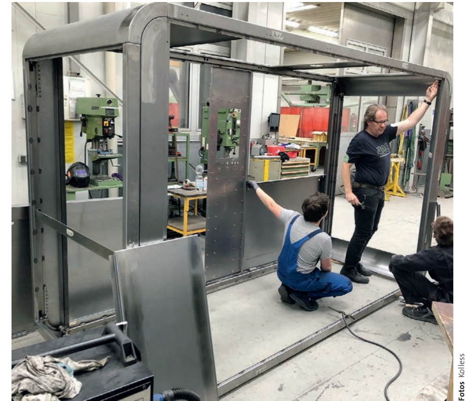
Umformen, kanten, schweißen, fügen, schleifen, polieren – so lange, bis ein erstklassiges funktionales Produkt nach Kundenwunsch entstanden ist: Lutz Abram (links) und seine Leute in der Spezialwerkstatt, in der unter anderem prototypische Gehäuse für spezielle Technologien gefertigt werden.
