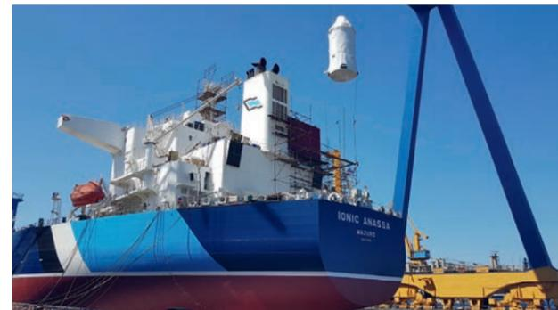
Ein Scrubber von Saacke wird an Bord eines Rohöltankers gehievt. Er kann den Schwefelgehalt des Abgases um 99 Prozent reduzieren.
